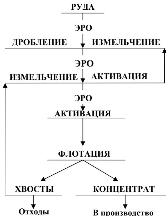
Рис. 4. Схема электроразрядного обогащения руд.
