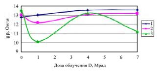
**Рис. 2.** Зависимость логарифмического значения удельного сопротивления от дозы облучения D:  $1-\Pi\Pi$ -96%/( $\alpha$ -Al $_2$ O $_3-1%+\alpha$ -Fe $_2$ O $_3-3%$ );  $2-\Pi\Pi$ -93%/( $\alpha$ -Al $_2$ O $_3-2%+\alpha$ -Fe $_2$ O $_3-5%$ );  $3-\Pi\Pi$ -90%/( $\alpha$ -Al $_2$ O $_3-3%+\alpha$ -Fe $_2$ O $_3-7%$ ).
