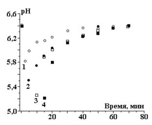
Рис. 5. Изменение pH при постэффекте в нейтральной среде (p $H_0$ =6,4), 0,0001 M, объем 400 мл, ток разряда 5 мА. Время обработки разрядом. 1-2,5; 2-5; 3-10; 4-15 мин
