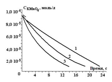
Рис. 7. Зависимость протекания постэффекта восстановления перманганата калия от времени обработки дистиллированной воды, мин: 1-10, 2-15, 3-20
