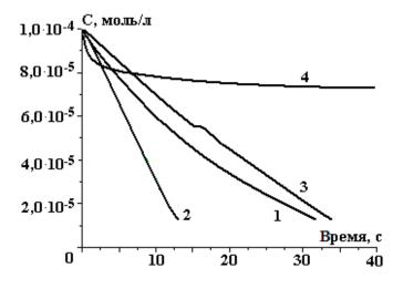
Рис. 6. Сравнение протекания постэффекта в дистиллированной воде (1) и растворах электролитов: 0,1 M KCl (2), 0,1 M Na<sub>2</sub>SO<sub>4</sub> (3), 0,1 M Na<sub>2</sub>CO<sub>3</sub> (4)
