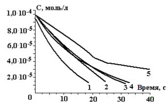
Рис. 8. Зависимость протекания постэффекта восстановления  $KMnO_4$  от времени выдержки обработанной воды. 1 - без выдержки, 2 - 5 мин, 3 - 15 мин, 4 - 60 мин, 5 -сутки
