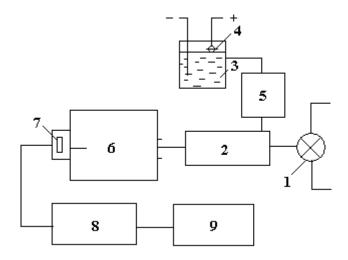
Рис. 1. Принципиальная схема установки для фотометрического определения перманганата калия. 1 — источник излучения; 2 — проточная кварцевая ячейка; 3 — раствор электролита; 4 — зона плазмы; 5 — перильстатический насос; 6 — монохроматор; 7 — фотоэлемент и усилитель; 8 — аналогоцифровой преобразователь; 9 — компьютер
