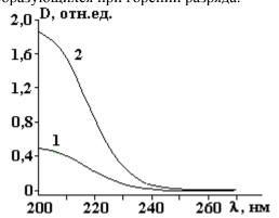
Рис. 10. Спектр поглощения:  $1-0,0005~M~HNO_3$ , 2- дистиллированной воды, обработанной тлеющим разрядом (время обработки -1 ч, ток 10~мA, объем -400~мл)
