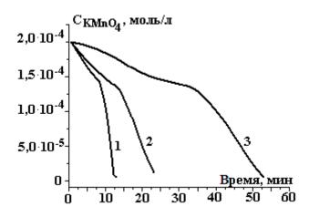
Рис. 2. Восстановление раствора  $KMnO_4$  при различных токах разряда, мA: 1-10; 2-5; 3-2,5; (концентрация 0,0002 M, объем раствора 400 Mл)
