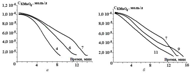
Рис. 3. Кинетические зависимости восстановления перманганата калия в кислой (а) и щелочной (б) средах. Цифры на кинетических кривых обозначают начальное значение pH раствора (0,0001~M, ток 5~mA, объем раствора 400~mn)
