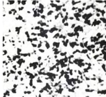
Рис. 2. Фотография поверхности железной композиции с объемной концентрацией  $p_V = 7,08\%$  и частицами окиси алюминия  $M_2$  в качестве дисперсной фазы
