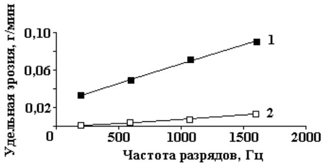
Рис. 2. Зависимость эрозии анода и катода от частоты импульсов при средней энергии импульсов  $E = 0,1$  Дж, длительности импульсов  $\tau = 60$  мкс; 1, 2 – удельная эрозия анода и катода соответственно
