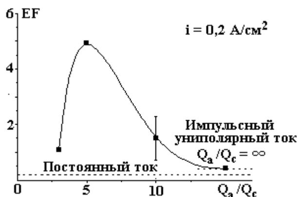
Рис. 4. Зависимость локализации травления от отношения плотностей пропущенного заряда в анодном и катодном импульсах при  $i = 0,2$  А/см<sup>2</sup>
