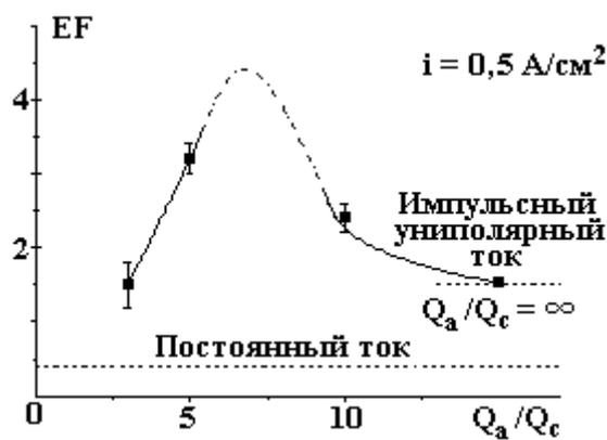
Рис. 5. Зависимость локализации травления от отношения плотностей пропущенного заряда в анодном и катодном импульсах при  $i = 0,5$  А/см<sup>2</sup>. Штрих-пунктиром показан возможный интервал  $Q_a/Q_c$ , в котором может наблюдаться увеличение локализации
