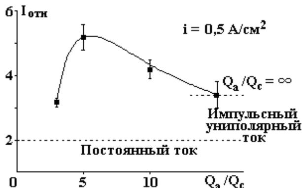
Рис. 9. Влияние условий обработки на величину сигнала при рентгенофазовом анализе пленки, полученной при травлении сплава (межплоскостное расстояние 3,71 Å), при средней плотности тока 0,5 А/см<sup>2</sup>
