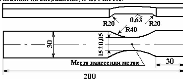
Рис. 1. Чертеж образцов, вырезанных из труб нефтяного сортамента с наружным диаметром 120 мм из стали 17Г1С
