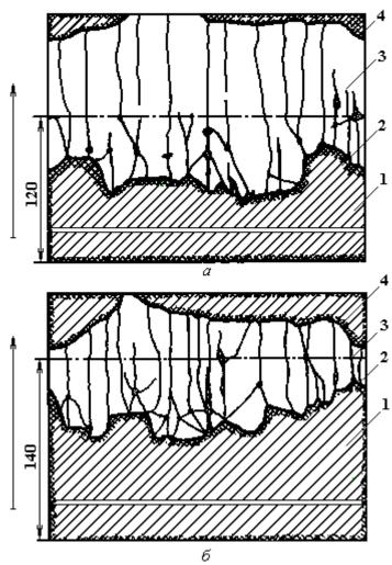
Визуальные схематизированные картины развертки внутренней поверхности образца стальной трубы 56х3 мм длиной 180 мм на завершающей стадии процесса ЭГИ очистки от прочных отложений толщиной 8 мм:
