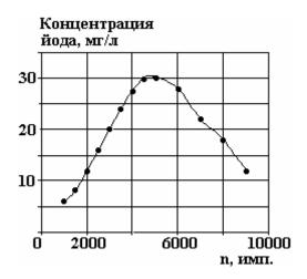
$Puc.\ 3.\ 3 aвисимость\ концентрации\ выделившегося\ J_2\ om\ количества\ импульсов\ электрического\ разряда$
