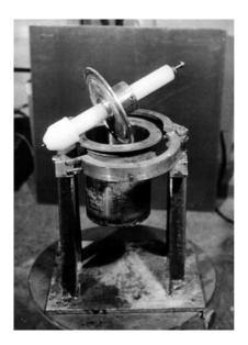
Рис. 2. Рабочая камера с электродной системой типа острие-плоскость
