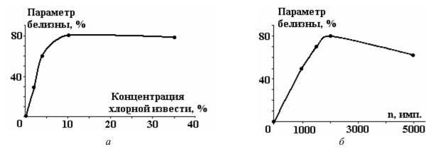
Рис. 4. Зависимость параметра белизны льняной ваты от концентрации хлорной извести (а) без электроразрядной обработки (время обработки – 60 мин, температура раствора 60–80  $^{0}$ C) и от количества импульсов (б) при концентрации хлорной извести 2%
