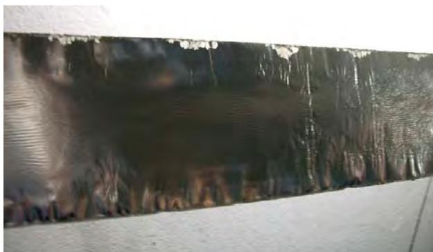
**Рис. 7.** Деметаллизация в месте контакта металлизированной обкладки со слоем шоопировки.
