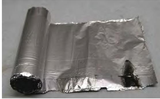
Рис. 8. Электрический пробой диэлектрика на краю обкладок секций.
