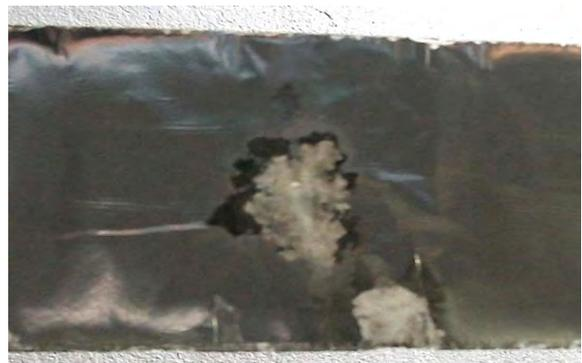
**Рис. 5.** Характерные места пробоя секций с металлизированными обкладками.
