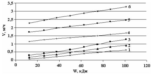
Объем разрушения донных прочных грунтов с прочностью  $\sigma_{cж}$ , МПа: 1-30, 2-40, 3-60 (без ЭС); 4-30, 5-40, 6-60 (с ЭС)
