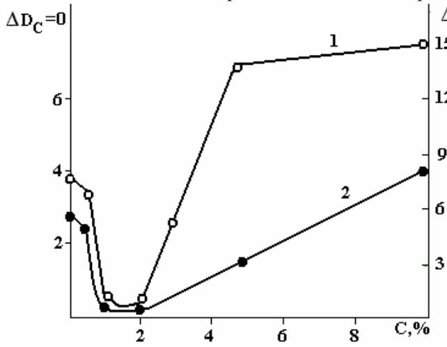
Рис. 1. Потеря массы  $\Delta m$  (1) и степень окисления (2) образцов ПЭ в зависимости от содержания ПП.  $U_{\text{стар}} = 9 \text{ кВ}$ ,  $t_{\text{стар}} = 20 \text{ час}$
