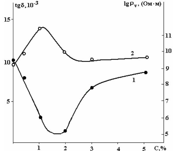
Рис. 2. Изменения тангенса диэлектрических потерь  $\text{tg}\delta$  (1) и удельного сопротивления  $\lg \rho_v$  (2) образцов ПЭ в зависимости от содержания ПП
