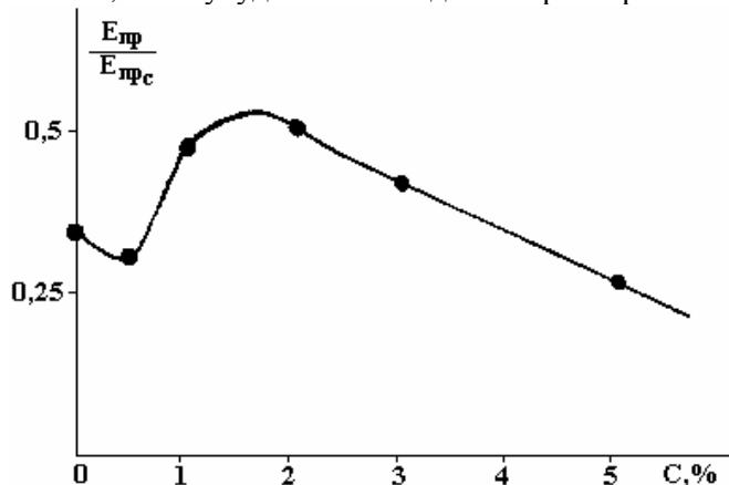
Рис. 3. Зависимость электрической прочности  $E_{np}$  образцов ПЭ с различным содержанием ПП.
