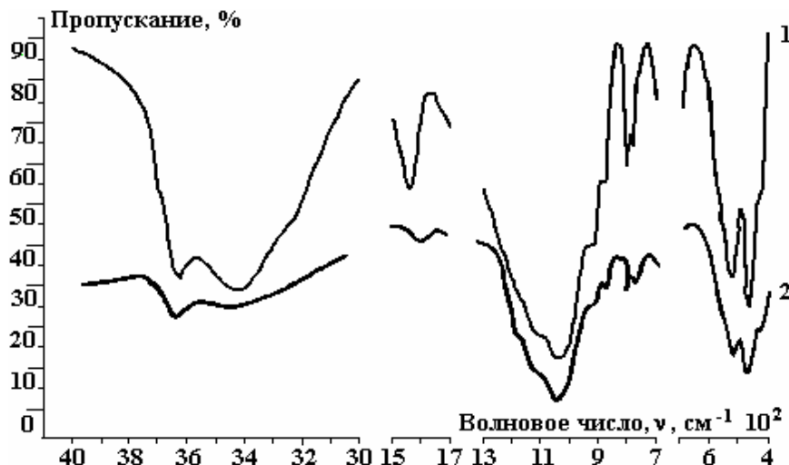
Рис. 3. ИК-спектры воздушно-сухого (1) и термообработанного бентонита (2)
