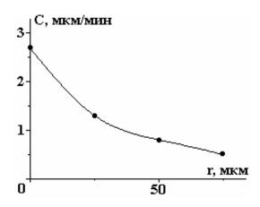
$Puc.\ 1.\ 3$ ависимость скорости травления  $\Im\Phi\Gamma\Pi$  от расстояния до частицы катализатора
