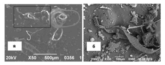
Рис. 8. Конгломерат нанотрубок (a), увеличенный фрагмент (б), на котором видны нанотрубки, упакованные в ленту
