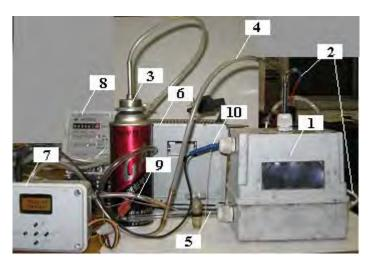
Рис. 3. Экспериментальная установка для электроразрядного синтеза наноуглеродных материалов
