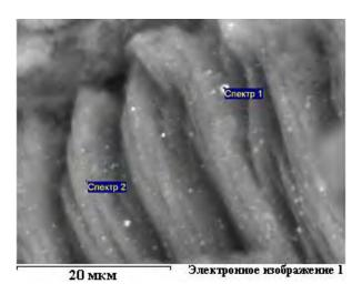
Рис. 9. Нанотрубки, упакованные в ленту (фрагмент рис. 8 при большем увеличении)
