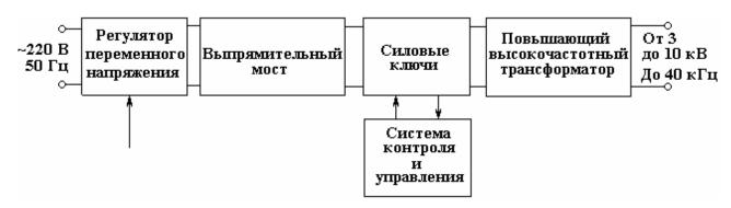
Рис. 2. Структурная схема генератора
