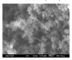
Рис. 5. Наноструктура синтезированных углеродных материалов
