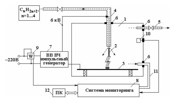
Рис. 1. Структурная схема экспериментальной установки для электроразрядного синтеза наноуглеродных материалов из газового углесодержащего сырья
