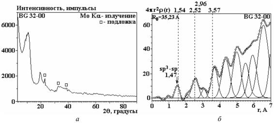
Рис. 10. Дифрактограмма (а) и ФРРА (б) продуктов электроразрядного синтеза наноуглерода
