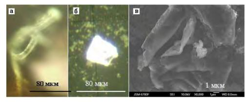
Рис. 6. Микротрубки (а), микроалмазы (б) и многослойные нанопленки (в), полученные в результате электроразрядного синтеза в газообразной среде
