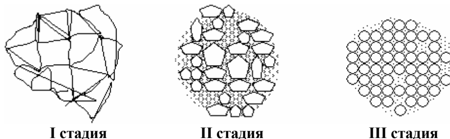
Рис. 1. Постадийная электроразрядная дезинтеграция угля
