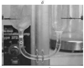
$Puc.\ 1.\ Внешний вид подводных разрядов.\ a-диафрагменный;\ б-торцевой;\ в-разряд в длинной ди-электрической трубке, заполненной электролитом$
