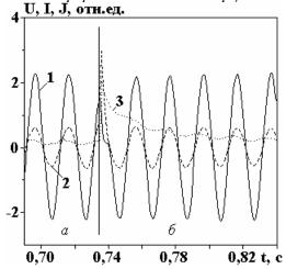
Рис. 5. Ток в ячейке (1), напряжение (2) и интенсивность интегрального излучения (3).  $Na_2SO_4$  0,05 М **U, I, J, отн.ед.**
