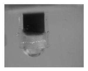
Рис. 2. Микроразряды в кольцевом зазоре между пузырем и стенкой трубки («тихий» разряд)
