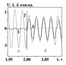
Puc.3. Ток в ячейке (1), напряжение (2) и интенсивность интегрального излучения (3).  $Na_2SO_4$  0,01 M
