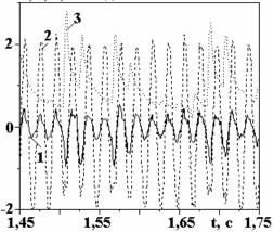
Рис. 6. Осциллограммы тока (1), напряжения (2) и интенсивности интегрального излучения (3),  $Na_2SO_4$  0,04 М. Повторные зажигания активной формы разряда
