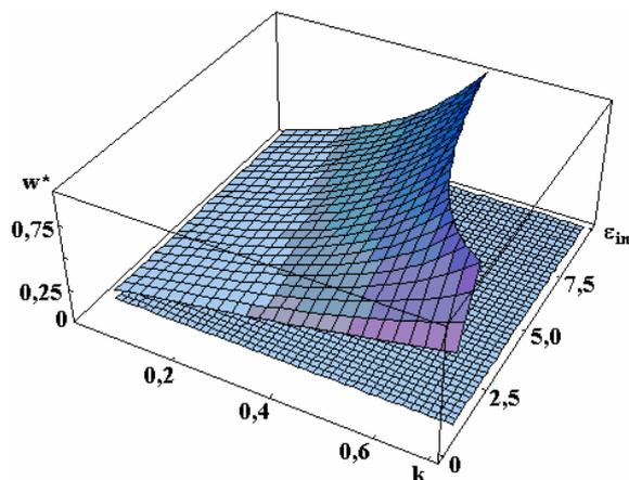
Рис. 5,а. Связь между параметрами  $W$ ,  $k$  и  $\epsilon_{in}$ , определяющими при  $\epsilon_{ex} = 1$  положение левой границы зоны неустойчивости. Нижняя, более часто заштрихованная плоскость, указывает уровень  $W = 0$
