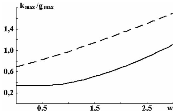
Рис. 4. Зависимости волнового числа волны с максимальным инкрементом (пунктирная линия) и самого максимального инкремента (сплошная линия) от зарядового параметра  $W$ , рассчитанные при  $\epsilon_{ex} = 1$  для жидкости с  $\epsilon_{in} = 7$
