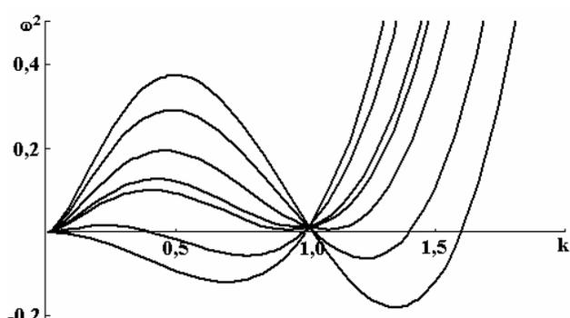
Рис. 2,б. Зависимости квадрата частоты волны от волнового числа, рассчитанные для жидкого водорода при  $\epsilon_{ex} = 1$  и различных значениях параметра  $W$  (снизу вверх по левому краю):  $W = 0$ ;  $W = 0,35$ ;  $W = 0,87$ ;  $W = 1$ ;  $W = 1,33$ ;  $W = 1,8$ ;  $W = 2,2$
