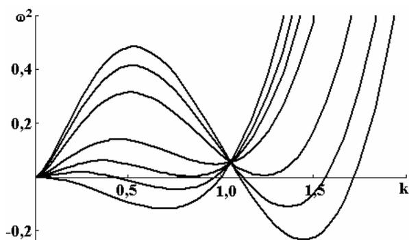
Рис. 2,а. Зависимости квадрата частоты волны от волнового числа, рассчитанные для жидкого гелия при  $\epsilon_{ex} = 1$  и различных значениях параметра  $W$  (снизу вверх по левому краю):  $W = 0$ ;  $W = 0,35$ ;  $W = 0,615$ ;  $W = 1$ ;  $W = 1,77$ ;  $W = 2,2$ ;  $W = 2,5$
