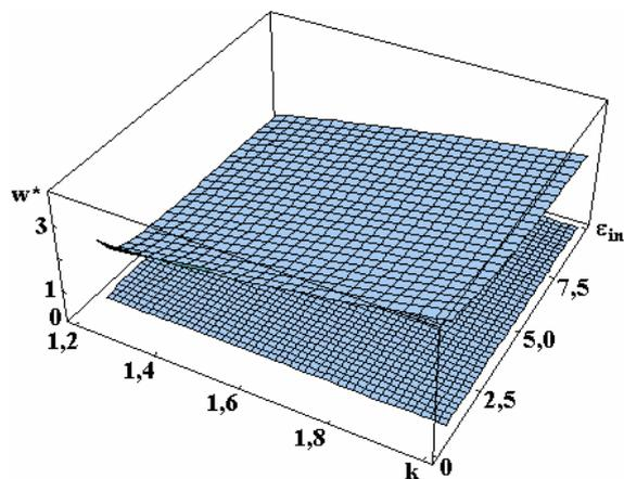
Рис. 5,б. Связь между параметрами  $W$ ,  $k$  и  $\epsilon_{in}$ , определяющими при  $\epsilon_{ex} = 1$  положение правой границы зоны неустойчивости. Нижняя, более часто заштрихованная плоскость, указывает уровень  $W = 0$
