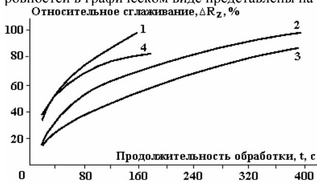
Рис. 5. Изменение относительного сглаживания высоты микронеровностей поверхности образцов в результате ЭХП с течением времени обработки: 1 – ЭХП биполярными импульсами без предварительной обработки; 2 – ЭХП унipoлярными импульсами без предварительной обработки; 3 – ЭХП унipoлярными импульсами при предварительной обработке наждачной бумагой; 4 – ЭХП унipoлярными импульсами при предварительной обработке надфилем
