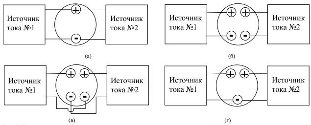
**Рис. 1.** Примеры вариантов электродных систем: (а) – двухэлектродная система; (б) – четырехэлектродная с параллельными токами; (в) – четырехэлектродная со скрещенными токами; (г) – трехэлектродная с V-образными токами.
