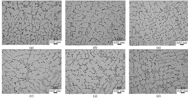
**Рис. 8.** Микроструктуры образцов-свидетелей: (а) — без обработки, контрольный; (б) — АС (50  $\Gamma$ ц),  $I_0 = 40$  A, время обработки 16 мин; (в) — DC(100  $\Gamma$ ц),  $I_0 = 40$  A, время обработки 16 мин; (г) — одновременная обработка AC+DC,  $I_0 = 20$  A, время обработки 16 мин; (д) — одновременная обработка AC+DC,  $I_0 = 20$  A, время обработки 10 мин; (е) — одновременная обработка AC+DC,  $I_0 = 20$  A, время обработки 5 мин.
