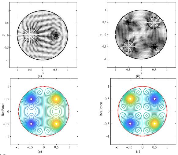
**Рис. 4.** Векторные поля и эквипотенциалы напряженности электрического поля для двух- и четырехэлектродных систем при СС: (а) — векторное поле напряженности для двухэлектродной системы; (б) — векторное поле напряженности для четырехэлектродной системы; (в) — эквипотенциалы электрического поля для четырехэлектродной системы (параллельные токи); (г) — эквипотенциалы электрического поля для четырехэлектродной системы (скрещенные токи).
