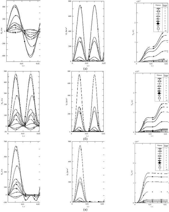
**Рис. 7.** Зависимости амплитудных значений магнитного  $(H_z)$ , теплового (Q) и поля скоростей  $(V_p)$  от времени в точках визуализации для *z*-компоненты: (a) – AC (50  $\Gamma$ ц); (б) – DC (100  $\Gamma$ ц); (в) – AC+DC.
