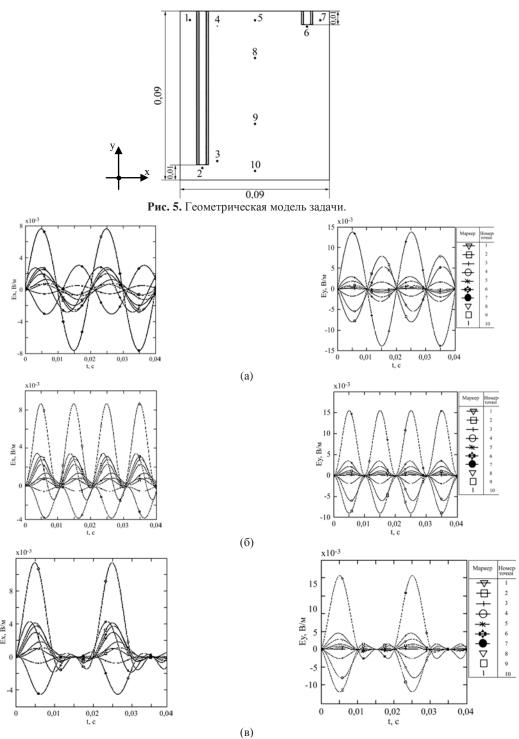
**Рис. 6.** Зависимости амплитудных значений электрического поля от времени в точках визуализации: (а) – x- и y-компоненты напряженности электрического поля AC (50  $\Gamma$ ц); (б) – x- и y-компоненты напряженности электрического поля DC (100  $\Gamma$ ц); (в) – x- и y-компоненты напряженности электрического поля AC+DC.
