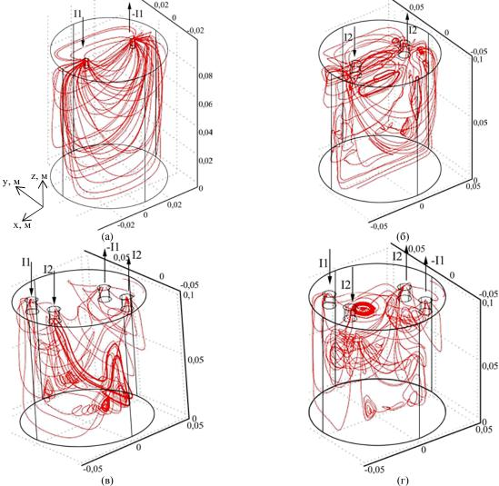
**Рис. 3.** Варианты распределения базового электрического поля при разных типах токов; (а) — тип тока  $I_1$  — CC, два электрода; (б) — тип тока  $I_2$  — AC (5к $\Gamma$ ц), два электрода; (в) — типы тока:  $I_1$  — CC,  $I_2$  — AC (5к $\Gamma$ ц), четыре электрода, параллельные токи; (г) — типы тока:  $I_1$  — CC,  $I_2$  — AC(5к $\Gamma$ ц), четыре электрода, скрещенные токи.
