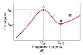
**Рис. 5.** Схематическое изображение начальной стадии процесса ЭЭО диэлектриков, состоящей из трех этапов (а); вольтамперная характеристика электролитов для трех этапов начальной стадии процесса ЭЭО (б).
