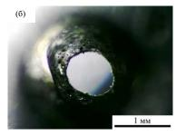
Рис. 2. Образец стеклянной пластины до (а) и после (б) электроэрозионной обработки в электролите.
