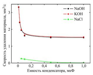
**Рис. 4.** Зависимость скорости удаления стеклянной пластины от емкости конденсатора в водных растворах электролитов NaCl, NaOH и KOH.
