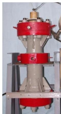
**Рис. 2.** Схема технологической части испытательного стенда (а): 1 – камера высокого давления; 2 – электродная система «Скиф»; 3 – электроды электродной системы типа острие (анод) – плоскость (катод); 4 – канал разряда; 5 – насос высокого давления; 6 – манометр; 7 – система сброса давления; 8 – технологическое отверстие для установки дополнительной регистрирующей аппаратуры. Общий вид разрядной камеры высокого давления (б).
