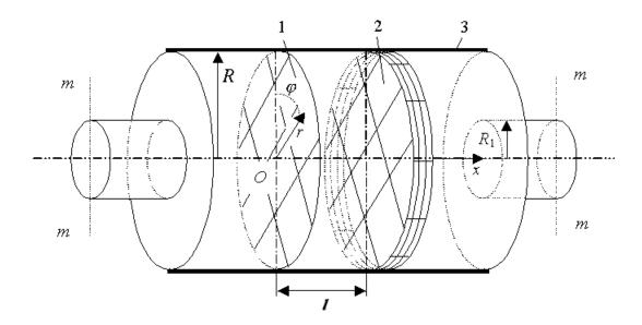
Рис. 1. Сеточный ЭГД насос, включенный в замкнутый внешний контур (сечения тт совпадают). 1- инжекционный электрод (эмиттер); 2- деионизационная камера (коллектор); 3- диэлектрический корпус насоса.
