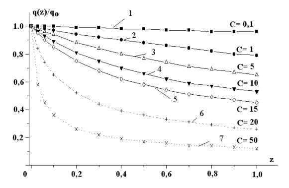
Рис. 4. Зависимость  $q(z)/q_0$  om z = x/l при  $\gamma = 1$  ( $E_0 = 5.8 \cdot 10^7$  В/м).
