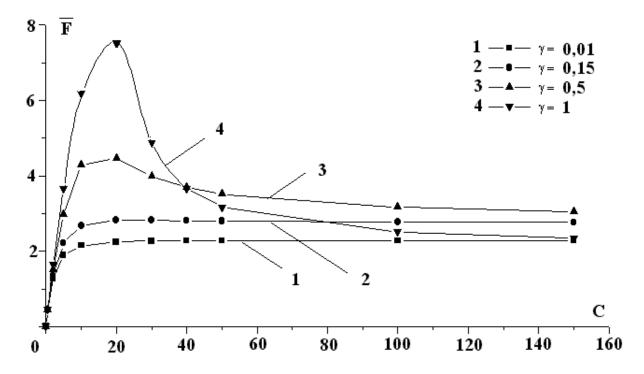
$Puc.\ 2.\ 3 a в u c u м o c m b n o л h o й к ул o h o в c к o й c u л ы <math>\overline{F}$  o m C n pu p a з л u ч h ы х  $\gamma$ .
