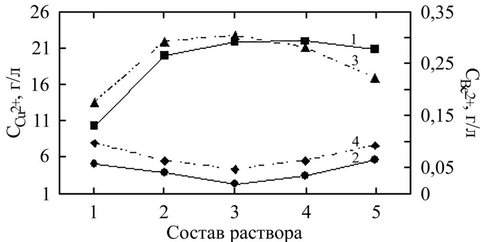
1, 2 – концентрации ионов Cu<sup>2+</sup>, г/л в растворе после травления 200 и 20 мин соответственно; 3, 4 – концентрации ионов Be<sup>2+</sup>, г/л в растворе после травления 200 и 20 мин соответственно.
