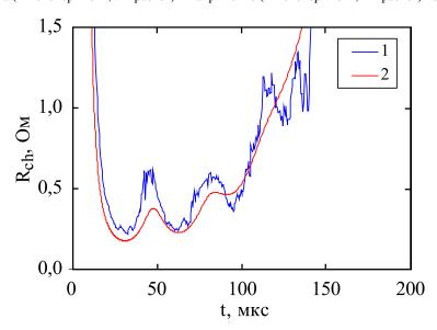
**Рис. 4.** Электрическое сопротивление канала разряда ( – эксперимент; 2 – расчет).
