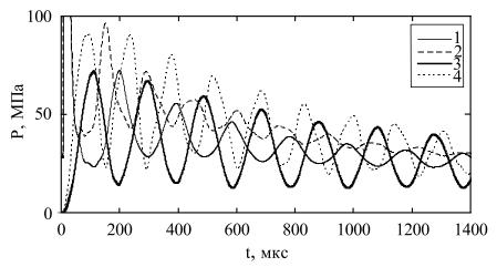
**Рис. 13.** Изменение давления в канале разряда (I и 2) (после 150 мкс в парогазовой полости) и среднего давления в полости разрядной камеры (3 и 4) с различным ее радиусом: I и 3-60 мм; 2 и 4-40 мм.
