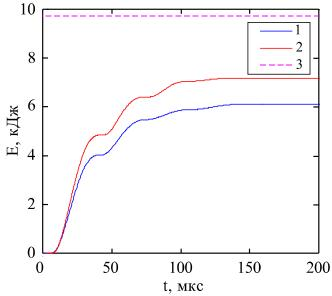
**Рис. 6.** Энергия, введенная в канал разряда (1 – эксперимент; 2 – расчет) и запасаемая в конденсаторной батарее (3).
