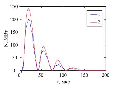
**Рис. 5.** Мощность ввода энергии в канал разряда ( – эксперимент; 2 – расчет).
