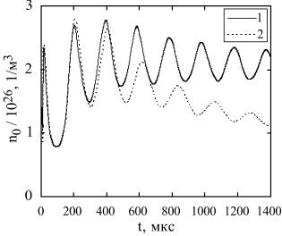
**Рис. 11.** Изменение концентрации частиц в канале разряда (после 150 мкс в парогазовой полости) в процессе пульсаций: I – без учета излучения из канала разряда; 2 – с учетом излучения из канала разряда.
