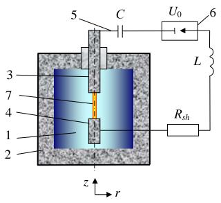
**Рис. 1.** Схема моделируемой системы: I — полость разрядной камеры, заполненная водой; 2 — корпус разрядной камеры; 3 — высоковольтный электрод; 4 — низковольтный электрод; 5 — разрядный контур; 6 — воздушный разрядник; 7 — канал разряда; C — емкость конденсаторной батареи;  $U_0$  — напряжение заряда конденсаторной батареи; L — индуктивность разрядного контура;  $R_{sh}$  — сопротивление элементов разрядного контура (без канала разряда).
