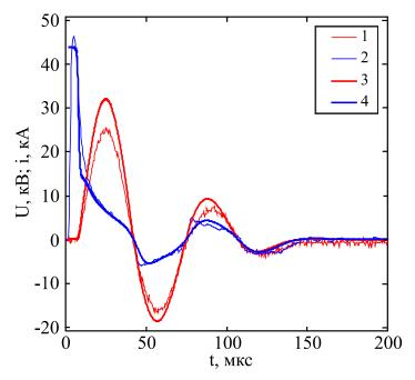
**Рис. 3.** Сила тока (1 - эксперимент; 3 - расчет) и напряжение (2 - эксперимент; 4 - расчет) на канале разряда.
