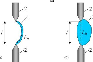
**Рис. 2.** Форма канала в начале (a) и на развитой стадии разряда в воде (б): I – форма профиля канала в плоскости оси электродов; 2 – электроды; l – расстояние между электродами;  $l_{ch}$  – длина кратчайшего пути движения электронов в канале (штриховая линия).
