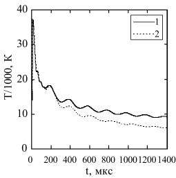
**Рис. 10.** Изменение температуры в канале разряда (после 150 мкс в парогазовой полости) в процессе пульсаций: I- без учета излучения из канала разряда; 2- с учетом излучения из канала разряда.
