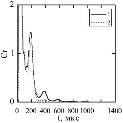
**Рис. 9.** Изменение коэффициента поглощения излучения энергии из канала разряда (после 150 мкс из парогазовой полости) его поверхностью: I — без учета излучения из канала разряда; 2 — с учетом излучения из канала разряда.
