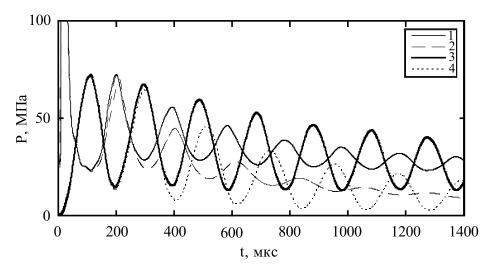
**Рис. 8.** Изменение давления в канале разряда (I и 2) (после 150 мкс в парогазовой полости) и среднего давления в полости разрядной камеры (S и S): S и S — без учета излучения энергии; S и S — с учетом излучения энергии.
