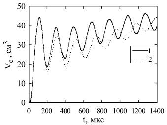
**Рис. 12.** Изменение объема канала разряда (после  $150\,\mathrm{mkc}$  парогазовой полости) в процессе пульсаций: I – без учета излучения из канала разряда; 2 – с учетом излучения из канала разряда.
