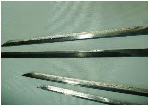
Рис. 10. Пример обработки режущего инструмента при безвибрационном легировании.
