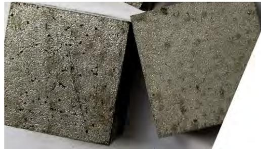
Рис. 9. Пример ЭИЛ на частотах 1000 (слева) и 2000 Гц (справа).
