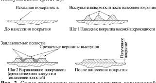
**Рис. 2.** Схема технологии получения покрытия повышенной толщины.
