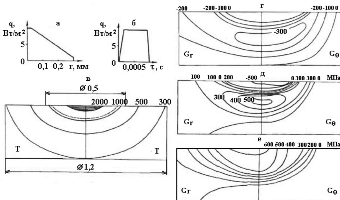
Зависимость интенсивности теплового потока от радиуса (*а*) и времени (*б*); температурное поле в момент окончания нагрева (*в*). Поля радиальных  $\sigma_r$  и окружных  $\sigma_\theta$  напряжений: (*з*) – в момент окончания нагрева; (*д*) – с учетом мартенситного превращения в стали; (*е*) – без учета фазовых превращений.
