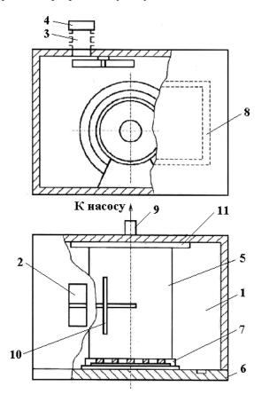
Плазменное разрядное устройство резонаторного типа: 1 - прямоугольный резонатор; 2 - отверстие связи; <math>3 - волноводный тракт; 4 - генератор электромагнитных колебаний; <math>5 - реактор; 6 - дверца; 7 - крышка реактора; 8 - дроссельные канавки; 9 - выходной патрубок; <math>10 - диссектор; 11 - фланец.
