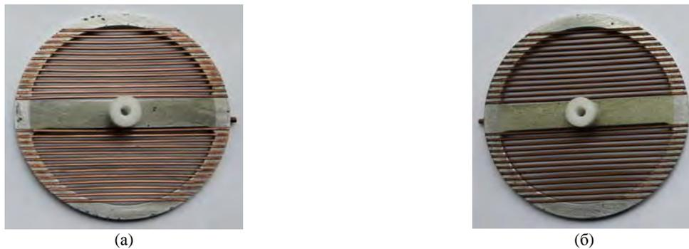
**Рис. 10.** Электрод-коллектор: (а) – первоначальное состояние; (б) – после ресурсных испытаний.
