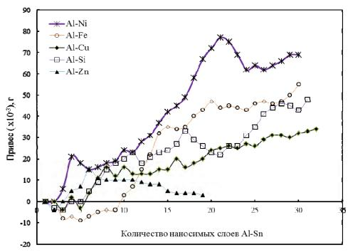
Зависимость привеса образцов из сплава Д1 от количества наносимых слоев электродом из сплава Al-Sn с использованием промежуточных барьерных слоев (Al-Cu, Al-Ni, Al-Si, Al-Zn).
