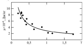
**Рис. 4.** Удельная энергетическая эффективность  $\mu = f(E_0, \gamma)$  при изменении величины средней напряженности  $E_0$  в пределах  $(5-10)\cdot 10^5$  В/м.
