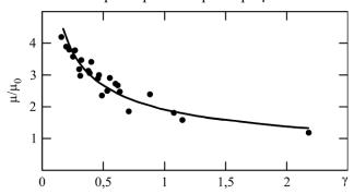
**Рис. 5.** Зависимость относительной величины удельной энергетической эффективности  $\mu/\mu_0$  ВЭС при ВЭХВ в ограниченных объемах от обобщенного параметра  $\gamma$  при  $\omega_{\tau}=(0.7-10)\cdot 10^6$  Дж/кг;  $E_0=(5-10)\cdot 10^5$  В/м;  $V_{\kappa}=(0.79-1.6)\cdot 10^{-3}$  м<sup>3</sup>.
