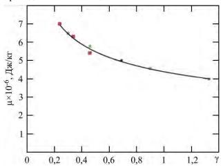
**Рис.** 2. Зависимость удельной энергетической эффективности  $\mu$  ВЭС при ВЭХВ в разных ограниченных объемах от обобщенного параметра  $\gamma$ .  $\blacksquare - V_\kappa = 0.79 \cdot 10^{-3} \text{ m}^3$ ;  $\blacktriangle - V_\kappa = 1.06 \cdot 10^{-3} \text{ m}^3$ ;  $\bullet - V_\kappa = 1.6 \cdot 10^{-3} \text{ m}^3$ ;  $\omega_\tau = 2.5 \cdot 10^6 \text{ Дж/кг}$  и  $E_0 = 0.67 \cdot 10^6 \text{ В/м}$ .
