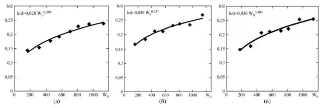
**Рис. 1.** Зависимости величин относительного прогиба мембран от энергии разряда: (a)  $-V_{\kappa}=1,6\cdot 10^{-3}\,\mathrm{m}^3$ ; (б)  $-V_{\kappa}=1,06\cdot 10^{-3}\,\mathrm{m}^3$ ; (в)  $-V_{\kappa}=0,79\cdot 10^{-3}\,\mathrm{m}^3$ .
