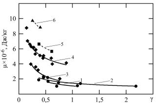
**Рис. 3.** Зависимость удельной энергетической эффективности  $\mu$  ВЭС при ВЭХВ в ограниченном объеме от обобщенного параметра  $\gamma$  при  $E_0=0.67\cdot 10^6$  В/м.  $I-\omega_{\tau}=0.7\cdot 10^6$  Дж/кг;  $2-\omega_{\tau}=1.0\cdot 10^6$  Дж/кг;  $3-\omega_{\tau}=1.5\cdot 10^6$  Дж/кг;  $4-\omega_{\tau}=2.5\cdot 10^6$  Дж/кг;  $5-\omega_{\tau}=5.0\cdot 10^6$  Дж/кг;  $6-\omega_{\tau}=10^7$  Дж/кг.
