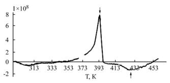
**Рис. 4.** Кривые ТСД нанокомпозиции  $\Pi\Pi$ +ZrO<sub>2</sub> при концентрации 5% ZrO<sub>2</sub> после поляризации под действием коронного разряда при T = 313 K в течение 5 мин.
