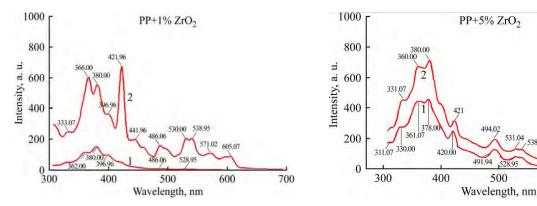
**Рис. 3.** Спектры люминесценции нанокомпозиции  $\Pi\Pi$ +ZrO<sub>2</sub> при концентрациях 1 и 5% до (1) и после (2) поляризации под действием коронного разряда.
