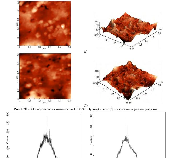
Рис. 2. Гистограмма шероховатости нанокомпозиции ПП+5% ZrO<sub>2</sub> до (а) и после (б) поляризации коронным разрядом.
