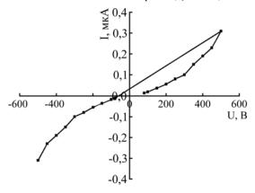
**Рис. 4.** Вольт-амперная характеристика обработанного образца ( $\tau_2 = 2$  часа).
