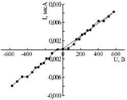
**Рис. 3.** Вольт-амперная характеристика обработанного образца ( $\tau_1 = 1$  час).
