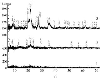
**Рис. 1.** Дифрактограмма природного адсорбента. I — необработанный электрическим разрядом; 2 — обработанный электрическим разрядом ( $\tau_1 = 1$  час); 3 — обработанный электрическим разрядом ( $\tau_2 = 2$  часа).
