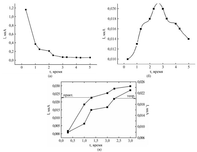
**Рис. 5.** Зависимости токов инжектированных зарядов от времени: (a) — необработанный адсорбент; (б) — обработанный электрическим разрядом адсорбент ( $\tau_1 = 1$  час); (в) — практические и теоретические значения токов для обработанного адсорбента ( $\tau_2 = 2$  часа).
