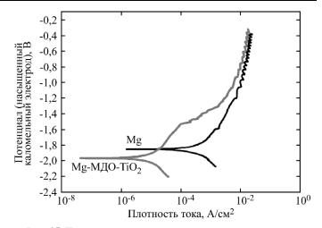
**Рис. 35.** Потенциодинамические поляризационные кривые, полученные в растворе Хенка, для образцов Mg и Mg-MДО-TiO $_2$  [19].
