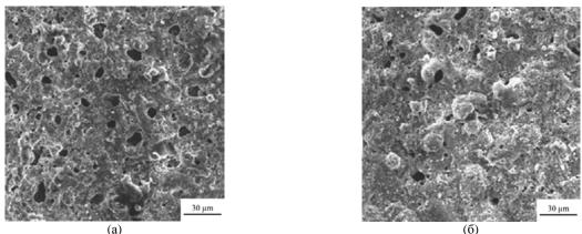
**Рис. 16.** Морфология поверхности МДО-покрытий, сформированных на TiAl сплаве в электролите  $Na_2SiO_3 + NaAlO_2 + Na_3PO_4 + NaF$ : (a) – без добавок; (б) – с комплексной графитсодержащей добавкой [9].
