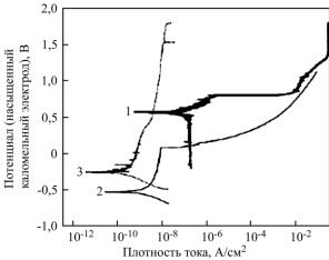
**Рис. 17.** Потенциодинамические поляризационные кривые, полученные в 3,5% растворе NaCl для образцов: I – TiAl сплав без покрытия; 2, 3 – с MДО-покрытиями, сформированными в электролитах  $Na_2SiO_3 + NaAlO_2 + Na_3PO_4 + NaF$  без добавок и с комплексной графитсодержащей добавкой соответственно [9].
