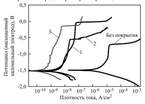
**Рис. 7.** Потенциодинамические поляризационные кривые, полученные в 3,5% растворе NaCl для алюминиевых образцов без покрытия и с MДО-покрытиями, сформированными в электролитах: I – без добавок графита; 2, 3 – с добавками графитового порошка со средним размером зерен 70 и 10 мкм соответственно [5].
