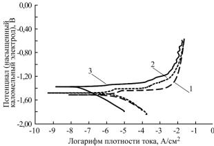
**Рис. 32.** Потенциодинамические поляризационные кривые, полученные в 3,5% растворе NaCl для образцов сплава AZ91D: I – без покрытия; 2 – с MДО-покрытием, сформированным в электролите без добавки золя  $Al_2O_3$ ; 3 – с добавкой золя  $Al_2O_3$  [17].
