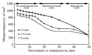
**Рис. 22.** Взаимосвязь между профилем микротвердости по толщине градиентных  $Si_3N_4/TiO_2$  – нанокомпозитных МДО-покрытий на титане и скоростью изменения коэффициента заполнения импульсной последовательности [11].
