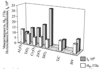
**Рис. 1.** Сравнительные данные по микротвердости  $H_{\mu}$  и интенсивности абразивного изнашивания  $I_h$  МДО-покрытий, сформированных на алюминиевых сплавах систем Al-Mg и Al-Cu-Mg в электролитах—суспензиях с добавками порошков оксидов, карбидов и нитридов [2].
