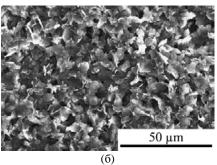
**Рис. 19.** Морфология поверхности: (а) — МДО-покрытие, сформированное на титановом сплаве Ti6Al4V; (б) — дуплексное покрытие [10].
