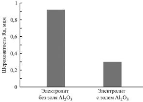
**Рис. 31.** Средняя шероховатость поверхности МДОпокрытий, сформированных на магниевом сплаве AZ91D в различных электролитах [17].
