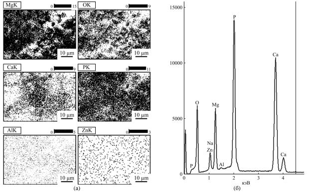
**Рис. 27.** Результаты ЭДС-анализа: (а) – распределение элементов (Mg, Ca, Al, J, P, Zn) по поверхности МДО-покрытия, сформированного на магниевом сплаве AZ31; (б) – общий спектр элементного состава [16].
