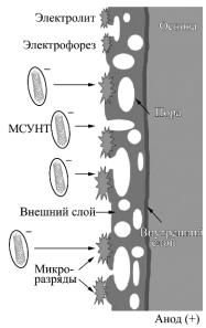
**Рис. 12.** Схематическая иллюстрация процесса инкорпорации МСУНТ во внешний слой МДО-покрытия [7].
