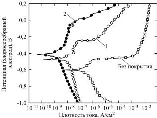
**Рис. 13.** Потенциодинамические поляризационные кривые, полученные в 3,5% растворе NaCl для образцов из алюминиевого сплава 7075 без покрытия и с МДО-покрытиями, сформированными в электролитах: *I* – без добавки МСУНТ; 2 – с добавкой МСУНТ [7].
