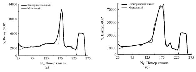
**Рис. 40.** Спектры ЯОР поверхностного слоя циркониевого сплава Э110 после МДО-обработки в электролите, содержащем: (a) -2 г/л КОН; (б) -2 г/л КОН и 12,5 г/л Na<sub>2</sub>SiO<sub>3</sub> [23].
