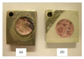
**Рис. 36.** Вид поверхности образцов Mg (а) и Mg-MДО-Tі $O_2$  (б) после погружных коррозионных испытаний в растворе Хенка в течение 15 дней [19].
