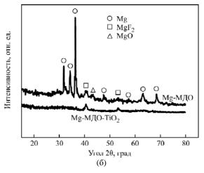
**Рис. 34.** Изменение элементного состава по глубине поперечного сечения образцов Mg-MДО- $TiO_2$  (а) и дифрактограммы поверхности образцов Mg-MДО и Mg-MДО- $TiO_2$  (б) [19].
