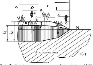
**Рис. 2.** Схема модели механизма формирования МДО-покрытий в электролитах—суспензиях: I — частица порошка в неизменном состоянии; 2 — химическое соединение с компонентами электролита; 3 — частица порошка, встроенная в кристаллическую решетку оксида алюминия; 4 — частица порошка в оболочке стабилизирующих полярных молекул (антикоагулянтов); 5 — частица порошка в зоне воздействия микроразряда [2].
