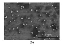
**Рис. 37.** Микрофотографии, иллюстрирующие морфологию поверхности образцов магниевого сплава WE42 после МДО (а) и с желатин/глютаральдегидным/ПМГК композиционным покрытием (б) [18].
