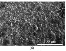
**Рис. 8.** Морфология поверхности МДО-покрытий, сформированных на алюминиевом сплаве 2024 в алюминатном электролите: (a) – без добавок графита; (б) – с добавками частиц графита (4 г/л) [6].
