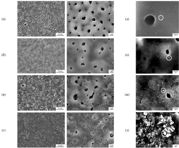
**Рис. 26.** Морфология поверхности МДО-покрытий, полученных на магниевом сплаве (1,55% Zn; 0,51% Zr) при плотности тока  $3 \text{ A/дм}^2$  за 3 мин в электролите, содержащем наночастицы серебра, г/л: (a) -0; (б), (д) -1; (в), (е) -3; (г), (ж) -5; (з) -5 (поврежденный участок) [15].
