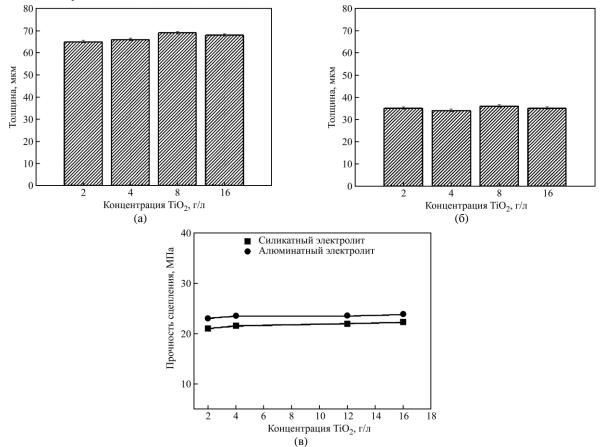
**Рис. 44.** Зависимость толщины (а), (б) и прочности сцепления с основой (в) МДО-покрытий, сформированных на углеродистой стали Q235, от концентрации добавок порошка  $TiO_2$  в алюминатный (а) и силикатный (б) электролиты [26].
