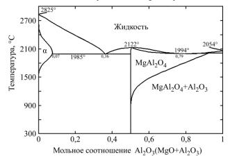
**Рис. 29.** Диаграмма фазового равновесия MgO-Al<sub>2</sub>O<sub>3</sub> [17].
