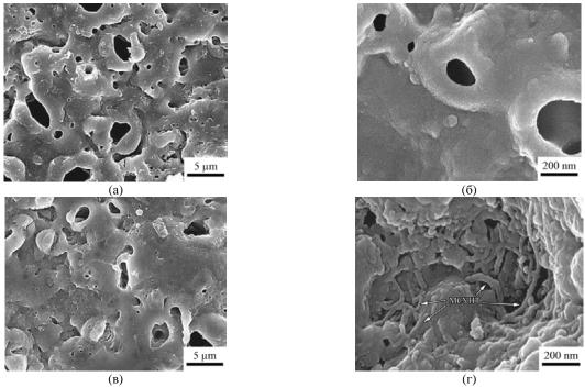
**Рис. 11.** Морфология поверхности МДО-покрытий, сформированных на алюминиевом сплаве 7075 в электролите  $Na_2SiO_3 + KOH + KF$ : (a), (б) – без добавки МСУНТ; (в), (г) – с добавкой МСУНТ [7].
