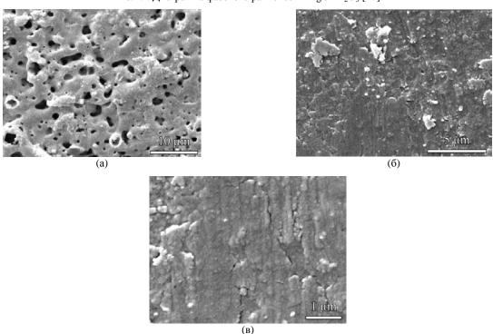
**Рис. 30.** Морфология поверхности МДО-покрытий на магниевом сплаве AZ91D, сформированных в электролитах: (а) — без добавки золя  $Al_2O_3$ ; (б), (в) — с добавкой золя  $Al_2O_3$ . Увеличение: (а) — маркер 10 мкм; (б) — маркер 5 мкм; (в) — маркер 1 мкм [17].
