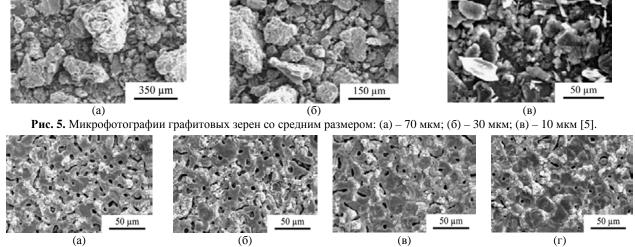
**Рис. 6.** Морфология поверхности МДО-покрытий, сформированных на алюминии в электролитах: (а) – без добавок графита; (б), (в), (г) – с добавками графитового порошка со средним размером зерен 70, 30 и 10 мкм соответственно [5].
