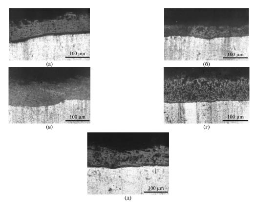
**Рис. 4.** Микрофотографии поперечных шлифов образцов с МДО-покрытиями, полученными на алюминиевом сплаве B95 в течение 150 минут в электролитах с добавками нанопорошка диоксида циркония: (а), (б) -2 г/л; (в), (г) -5 г/л; (д) -0 г/л. Способ получения нанопорошка ZrO<sub>2</sub>: (а), (в) -1 плазма CBЧ-разряда; (б), (г) -1 химическое осаждение [4].
