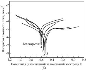
**Рис. 45.** Потенциодинамические поляризационные кривые, полученные в 3,5% растворе NaCl для образцов из углеродистой стали Q235 без покрытия и с МДО-покрытиями, сформированными в электролитах с добавками порошка  $TiO_2$  в алюминатный (а) и силикатный (б) электролиты: I-2 г/л; I-2
