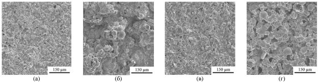
**Рис. 42.** Морфология поверхности МДО-покрытий, сформированных на углеродистой стали Q235 в алюминатном электролите с добавками порошка  $TiO_2$ : (a)  $-2 \ \Gamma/\pi$ ; (b)  $-4 \ \Gamma/\pi$ ; (b)  $-8 \ \Gamma/\pi$ ; (г)  $-16 \ \Gamma/\pi$  [26].
