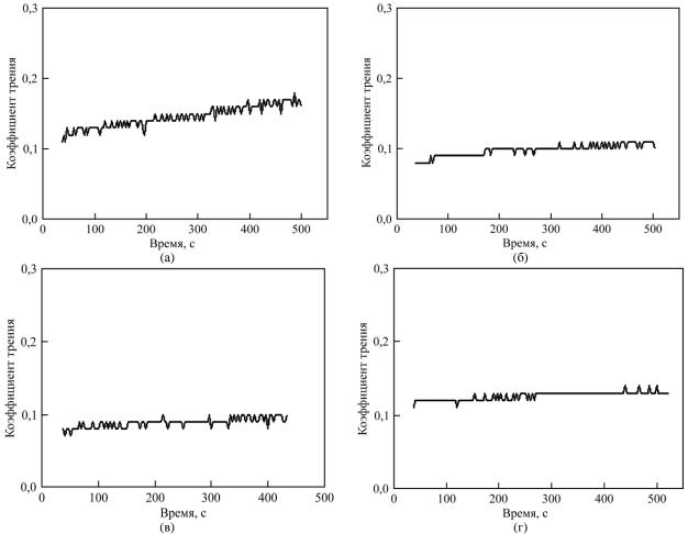
**Рис. 9.** Изменение коэффициента трения во время испытаний МДО-покрытий, сформированных на алюминиевом сплаве 2024 в электролитах с различной концентрацией добавок частиц графита: (а) -0 г/л; (б) -2 г/л; (в) -4 г/л; (г) -8 г/л [6].
