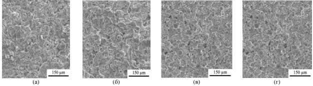
**Рис. 43.** Морфология поверхности МДО-покрытий, сформированных на углеродистой стали Q235 в силикатном электролите с добавками порошка  $TiO_2$ : (a) -2 г/л; (б) -4 г/л; (в) -8 г/л; (г) -16 г/л [26].
