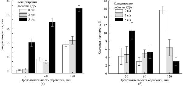
**Рис. 15.** Зависимость толщины (а) и сквозной пористости (б) покрытий, сформированных на алюминиевом сплаве B95, от продолжительности МДО-обработки и концентрации добавок УДА в силикатно-щелочной электролит [8].
