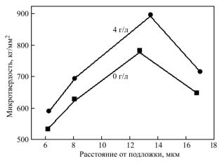
**Рис. 10.** Профиль микротвердости по толщине МДО-покрытий, сформированных на алюминиевом сплаве 2024 в алюминатном электролите без и с добавкой 4 г/л частиц графита [6].
