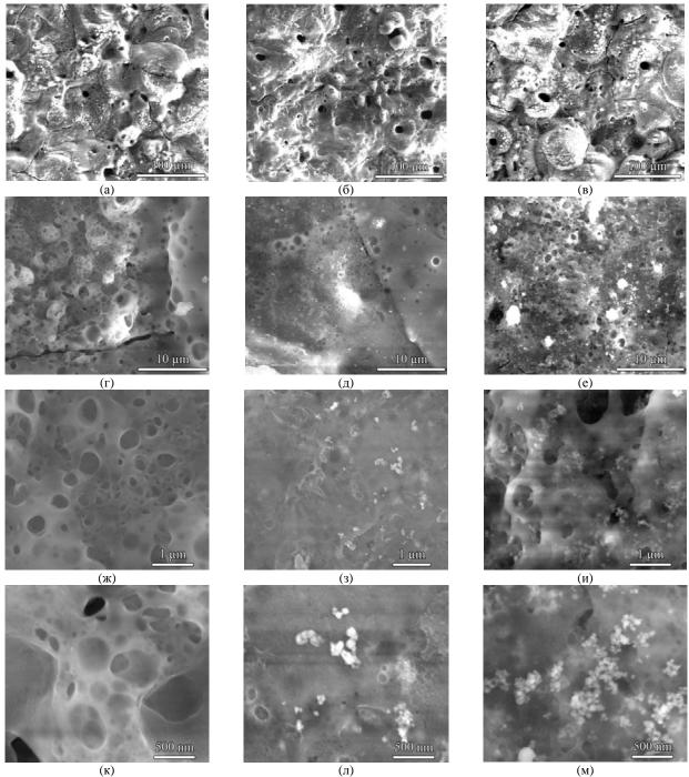
**Рис. 24.** Морфология поверхности МДО-покрытий, сформированных на магниевом сплаве MA2-1 в электролитах с добавками нанопорошка диоксида циркония различной концентрации: (а), (г), (ж), (к) -0 г/л; (б), (д), (з), (л) -2 г/л; (в), (е), (и), (м) -5 г/л [13].
