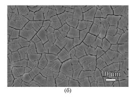
**Рис. 33.** Микрофотографии, иллюстрирующие морфологию поверхности образцов Mg-MДО (а) и Mg-МДО- $TiO_2$  (б) [19].
