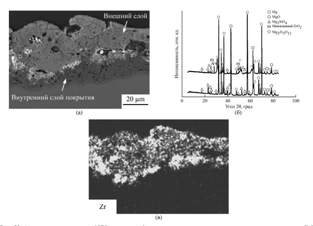
**Рис. 23.** (а) — поперечное сечение МДО-покрытия, сформированного на магнии в электролите с наночастицами ZrO<sub>2</sub>; (б) — дифрактограммы МДО-покрытий, сформированных на магнии в электролитах без (нижняя) и с (верхняя) наночастицами ZrO<sub>2</sub>; (в) — результаты энергодисперсионного рентгеновского элементного анализа содержания Zr в поперечном сечении МДО-покрытия (см. рис. 23а) [12].
