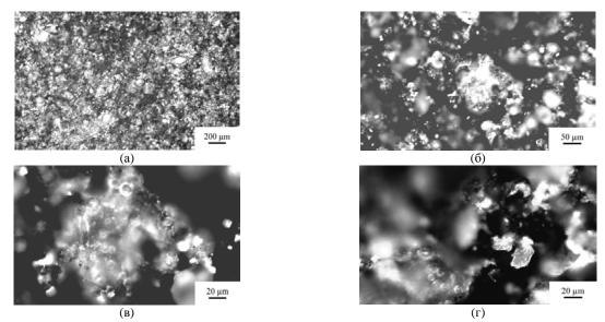
**Рис. 14.** Морфология поверхности МДО-покрытий, сформированных на алюминиевом сплаве B95 в силикатно-щелочном электролите с добавкой 5 г/л УДА. Увеличение: (а) – маркер 200 мкм; (б) – маркер 50 мкм; (в), (г) – маркер 20 мкм [8].
