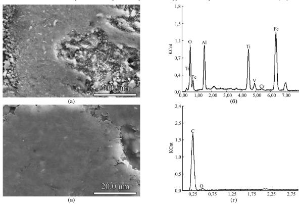
**Рис. 21.** Морфология дорожек износа МДО-покрытия, сформированного на титановом сплаве Ti6Al4V (а), и дуплексного покрытия (в) после скольжения по стальному шарику и результаты их ЭДС-анализа (б, г) [10].
