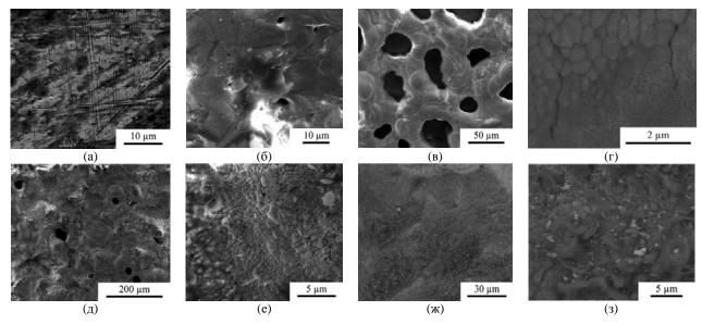
**Рис. 41.** Морфология поверхности МДО-покрытий на циркониевом сплаве 3110: (a) – исходный образец; (б) – МДО-обработка в щелочном электролите; (в), (г) – то же + 5 г/л нанопорошка  $Al_2O_3$ ; (д) – МДО-обработка в алюминатно-силикатно-щелочном электролите; (е) – то же + 2 г/л нанопорошка  $Y_2O_3$ ; (ж), (3) – то же, но + 5 г/л нанопорошка  $Y_2O_3$  [23].
