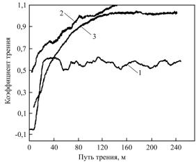
**Рис. 18.** Зависимость коэффициента трения от пути трения для образцов: I – TiAl сплав без покрытия; 2, 3 – с MДО-покрытиями, сформированными в электролитах  $Na_2SiO_3$  +  $NaAlO_2$  +  $Na_3PO_4$  + NaF без добавок и с комплексной графитсодержащей добавкой соответственно [9].
