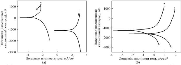
**Рис. 28.** Потенциодинамические поляризационные кривые, полученные в модельных биологических средах с pH 4,5 (a) и 7,4 (б) для образцов магниевого сплава AZ31: I – без покрытия; 2 – с MgO/гидроксиапатит MДО-покрытием [16].
