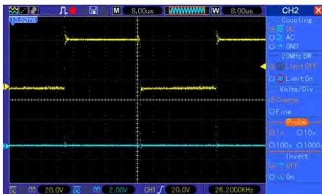
Рис. 1. Осциллограмма; источник напряжения с емкостным выходом.
