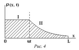
Таким образом, решена задача о релаксации объемных зарядов в одномерном ЭГД-потоке. На трех примерах показано, что процесс релаксации идет независимо в двух смежных областях, граница между которыми перемещается приблизительно с постоянной скоростью потока. Вследствие этого одна зона увеличивается за счет уменьшения другой. Длительность переходного процесса равна времени перемещения релаксационного фронта вдоль всего канала, через который течет жидкость.
