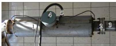
**Рис. 19.** Электроплазмоллизатор в технологической линии по переработке винограда: 1 – корпус; 2 – фланцы; 3 – мезгопровод технологической линии; 4 – клеммная коробка; 5 – кабель электропитания.
