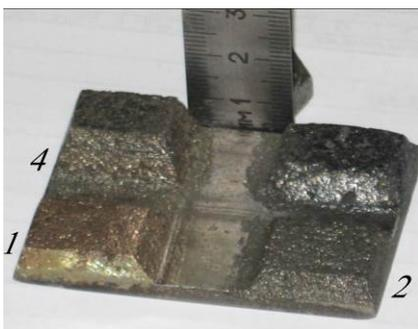
**Рис. 4.** Примеры толстослойных покрытий повышенной сплошности: 1 – бронза БрКМц3-1 – толщина 4,5 мм; 2 – нихром (X20H80) – толщина 4,7 мм; 3 – сталь 65Г – толщина 5,7 мм; 4 – нихром (3,9 мм) + БрКМц3-1 (+3,2 мм) + нихром (+3,1 мм) + Т15К6 (+0,1 мм) – общая толщина 10,3 мм.
