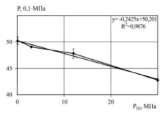
**Рис. 4.** Зависимость амплитуды волны давления от гидростатического давления.
