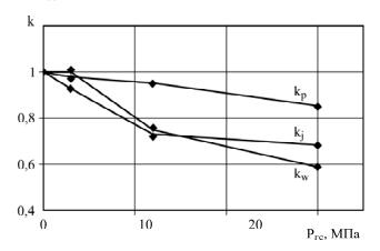
**Рис. 3.** Влияние гидростатического давления на параметры волны давления.
