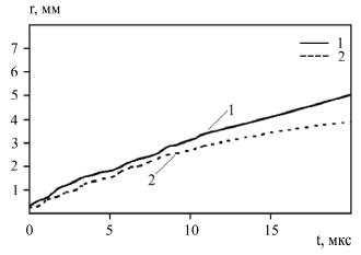
**Рис. 6.** Динамика расширения канала разряда: 1 – при гидростатическом давлении 0,1 МПа; 2 – при гидростатическом давлении 30 МПа.
