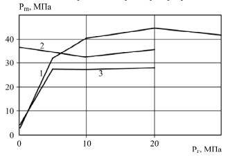
**Рис. 1.** Зависимость амплитуды давления от гидростатического давления при электроразряде в различных средах [7]: 1 — водонефтяная эмульсия + поверхностно-активное вещество (HMK-21); 2 — водный электролит,  $\sigma_0 = 0,1~{\rm Om}^{-1}{\rm M}^{-1};$  3 — 0,3% водный раствор HMK-21.
