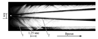
**Рис. 5.** Фотограмма расширения канала разряда (щелевая развертка): 1 – движение волны возмущения; 2 – движение стенки канала разряда.
