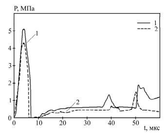
**Рис. 2.** Осциллограммы профиля волны давления: 1 — при гидростатическом давлении 0,1 МПа; 2 — при гидростатическом давлении 30 МПа.
