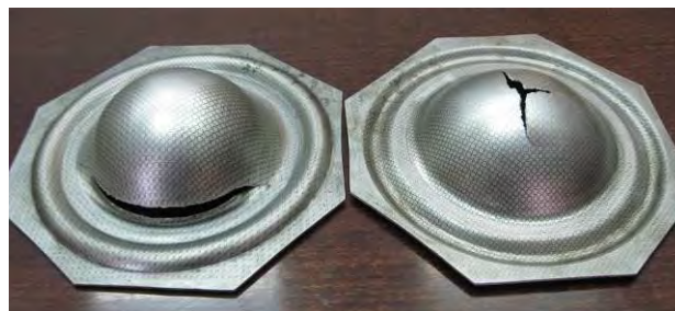
Рис. 2. Внешний вид разрушенных образцов (левый – разрушение от действия импульсно-статического нагружения; правый – от действия импульсного нагружения).
