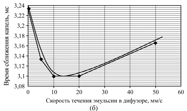
Рис. 10. Влияние скорости течения эмульсии на среднее время сближения капель: (а) – конфузор; (б) – диффузор.
