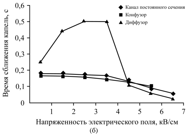
Рис. 8. Влияние напряженности электрического поля и формы канала на среднее время до касания капель: (а) – постоянное электрическое поле; (б) – переменное электрическое поле.
