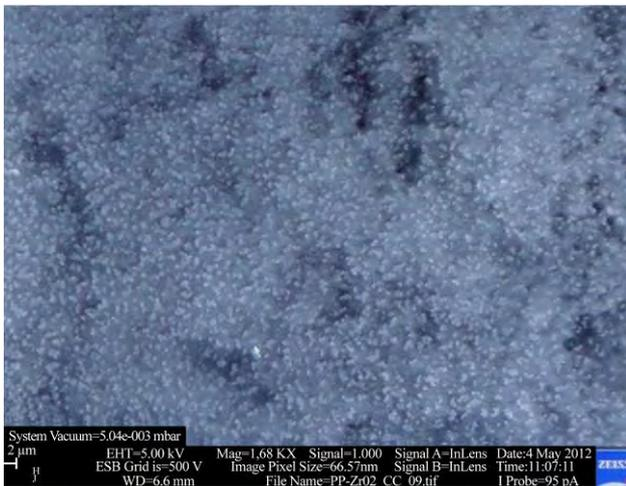
**Рис. 3.** Электронно-микроскопическое изображение нанокомпозитов на основе ПП+ZrO<sub>2</sub> (облучение поверхности пучком первичных электронов с энергией 5 кэВ).
