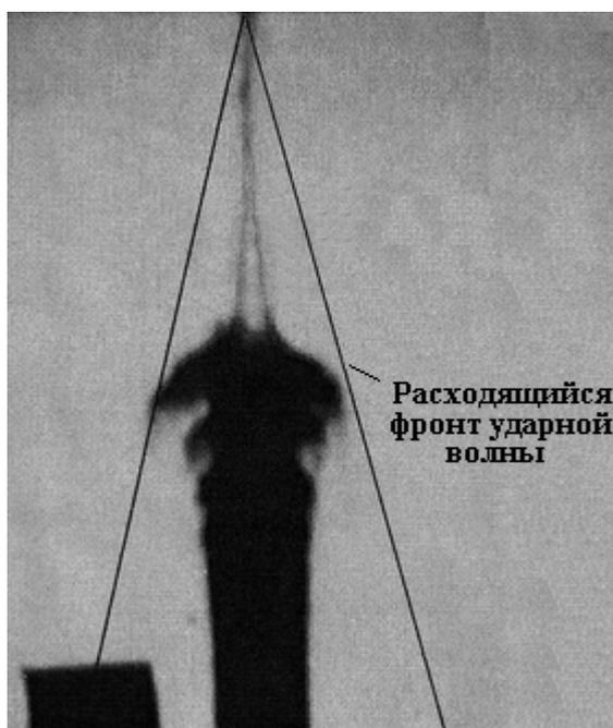
*Рис. 3. Схема расходящегося фронта ударной волны, порождаемой при движении со сверхзвуковой скоростью кумулятивной струи*
