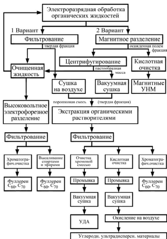
Рис. 3. Последовательность операций по разделению, очистке и обогащению производимых УНМ.
