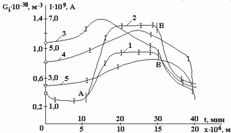
Зависимость силы тока  $I$  от времени  $t$  в случае предварительного облучения ПВХ (1-1 час) и ПВХ (2-3 час); концентрации  $C_i(x, t)$  электронов проводимости (3-5) после облучения ПВХ (3-3 час), ПВХ (4-3 час, 5-1 час) в момент времени  $t_1$  (3) = 8 мин,  $t_2$  (4) = 24 мин,  $t_3$  (5) = 32 мин в фиксированных точках  $x_3$  (3) = 0,5 x;  $x_4$  (4) = 0,8 x;  $x_5$  (5) = x; при  $T = 293 \text{ K}$ . А, В – собственно наличие и отсутствие источника  $\beta$ -излучения
