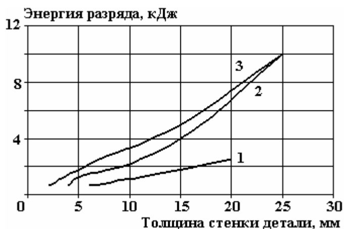
Рис. 2. Зависимость допустимых значений энергии разрядов от толщины стенок детали: 1 – Al 6; 2 – СЧ 28-48; 3 – Ст 45
