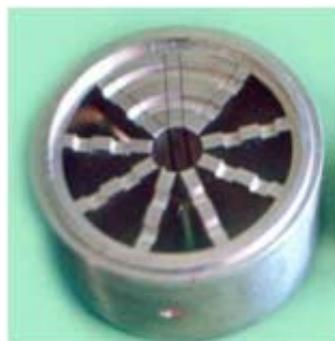
Рис. 25. Анодный блок амплитрона. Высота 50 мм.  $D = 62$  мм,  $d = 14$  мм. Ламели – 4 мм. Вырезано 7 резонаторов
