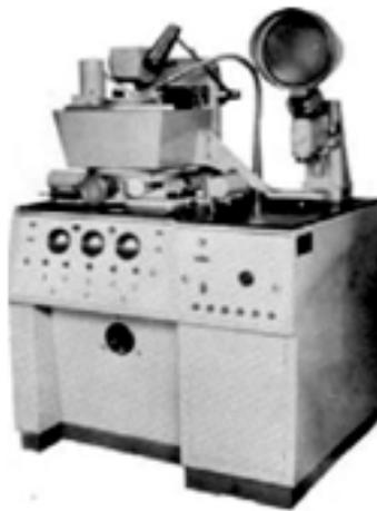
Рис.17. Установка А207.33 со встроенным тиратронным генератором импульсов
