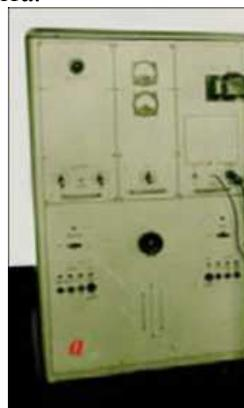
Рис. 21. Двухпозиционная установка А207.05 (в), одна из головок которой подключена к выводам импульсного трансформатора, встроенного в генератор (а)
