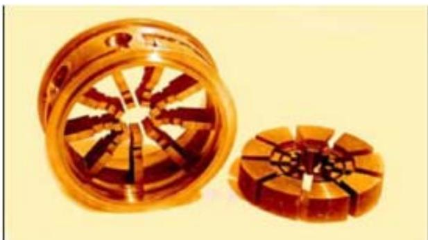
Рис. 24. Анодный блок амплитрона «Салют». Ламели: ширина – 4 мм, высота – 12 мм.  $D = 62$  мм,  $d = 14$  мм. Точность изготовления элементов – 0,01 мм. Справа – отходы
