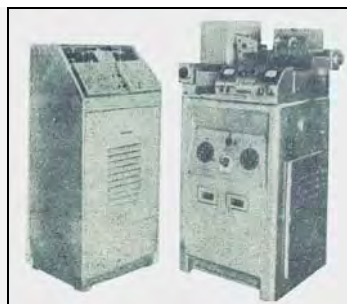
Рис. 2. Электроискровой станок модели 4531П с цифровым программным управлением, разработанный в ЦНИЛ-Электром в середине 1960-х годов
