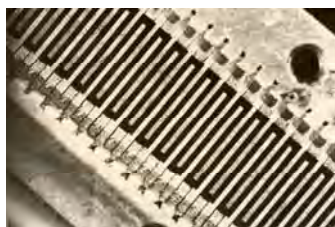
Рис. 11. Участок одной из первых сборных ЗС, пазы которой были прорезаны электроискровым способом электродом-проволокой \varnothing 40 мкм
