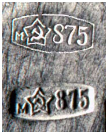
Рис. 19. Пример клеймения серебряных изделий: вверху – электроискровым способом, внизу – традиционным механическим
