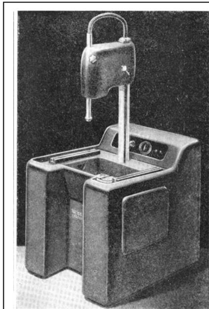
**Рис. 40.** Внешний вид электроискровой установки типа W/SM фирмы «Викман-Эродоматик»
